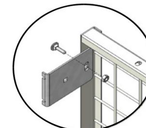
Pré-monter les brides longues sur les fonds grillagés avant de présenter les panneaux de fond sur le rayonnage. Prévoir 4 brides longues par panneau de fond. Le positionnement des brides longues de fixation doit être réalisé suivant le positionnement adopté pour les niveaux.
