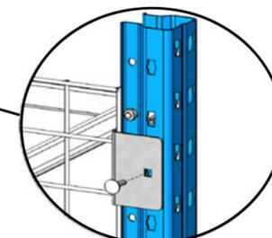
Répartir les brides courtes de fixation du grillage sur la hauteur de l'échelle. Fixer les brides sur les perforations latérales de l'échelle.
