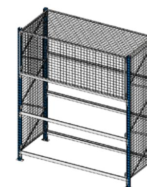
Débuter le montage des panneaux de fond par le haut du rayonnage afin de faciliter ensuite le positionnement des brides longues de fixation.
